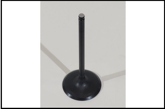
C11-5) Soupape admission - déposée Intake valve - dismantled
