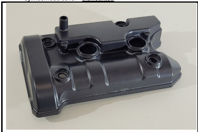
C1-3) Couvre culasse - déposé Cylinderhead cover - dismounted
