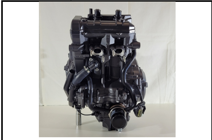
C1-3) Couvre culasse - déposé Cylinderhead cover - dismounted
