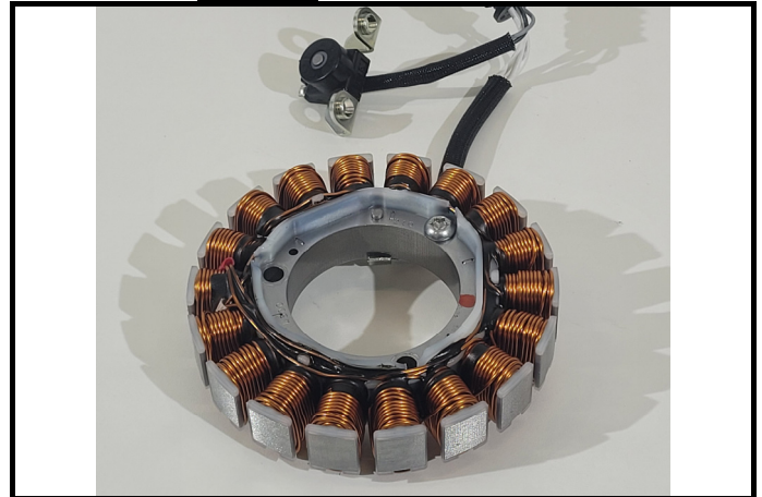
C15-2) Stator - déposé Stator - dismounted
