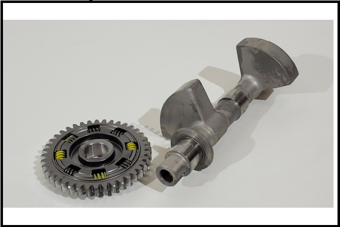
C3-10) Arbres déquibrage - démontés Balancing shafts - dismantled
