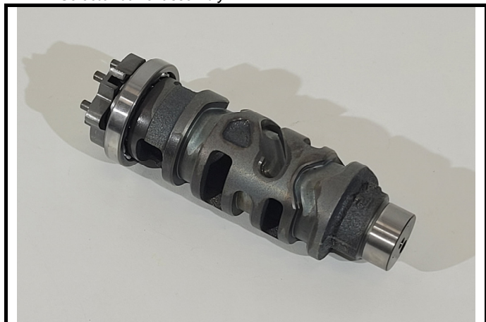
F9-5) Assemblage du barillet Selector barrel assembly
