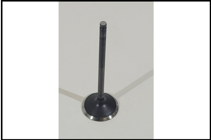
C12-1) Soupape échappement - déposée Exhaust valve - dismantled
