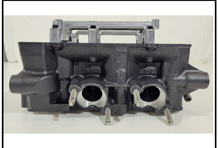
C8-4) Culasse nue vue côté échappement Bare cylinderhead seen from exhaust side
